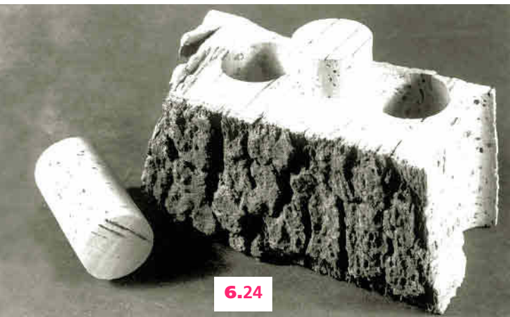
6-24. De gauche à droite : découpe dans une écorce de chêne-liège ; schéma de l'orientation radiale des lenticelles et, sur la surface, les cernes annuels d'accroissement du liège ; élasticité résiduelle produisant la forme d'un bouchon de champagne.
