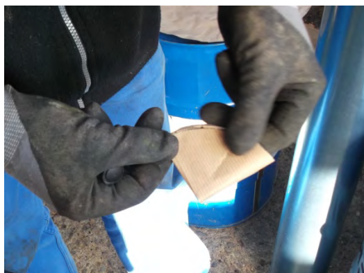
Pliage en quatre et utilisation d'une paire de ciseaux pour « écorner » le centre
