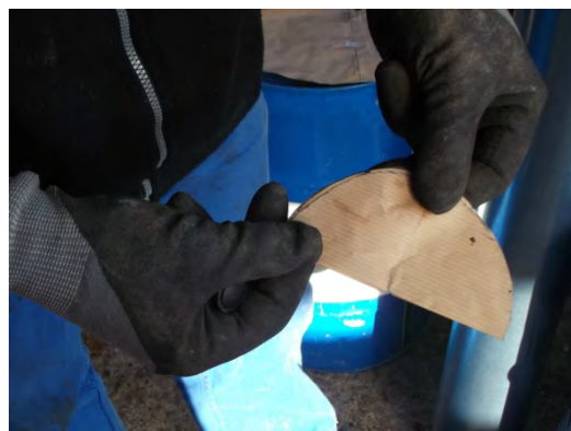
Pliage en quatre et utilisation d'une paire de ciseaux pour « écorner » le centre
