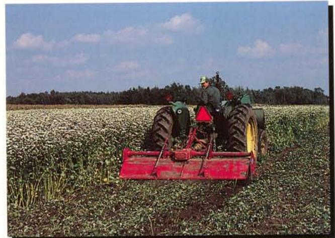
Broyage et incorporation superficiels d'un engrais vert de sarrasin avec un rotoculteur.
