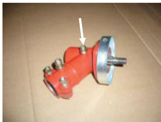
Bouchon vissé pour la lubrification.
