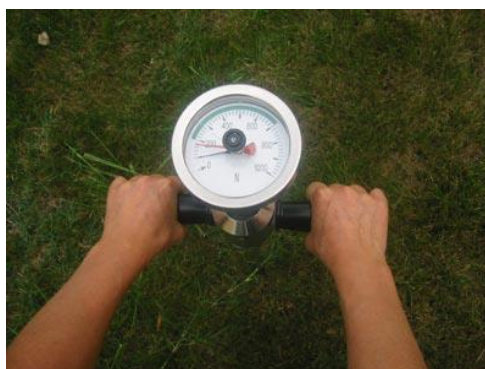
Figure 10 : PENETROMETRE STATIQUE MANUEL EMPLOYE POUR LA MESURE DE RESISTANCE MECANIQUE A LA PENETRATION DU SOL.
