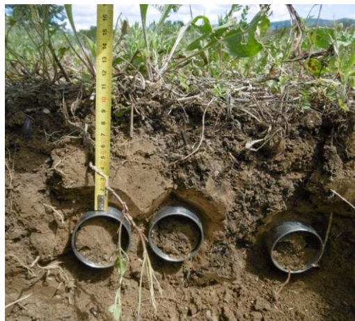
Figure 9 : PRELEVEMENT DE SOL DE L'HORIZON 10-15CM PAR LA METHODE DES CYLINDRES.
