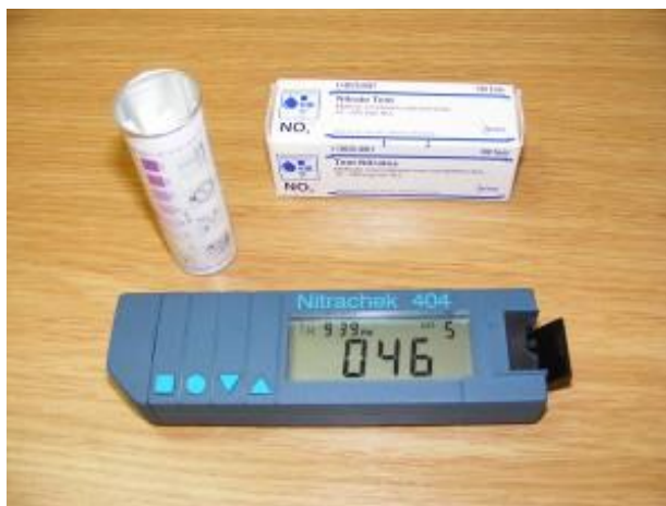
Figure 8 : NITRACHEK ET BADELETTES MERCKOQUANT UTILISES POUR LE DOSAGE DES NITRATES DANS LE SOL.
