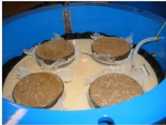
Figure 7 - Positionnement des échantillons dans appareil de Richards
