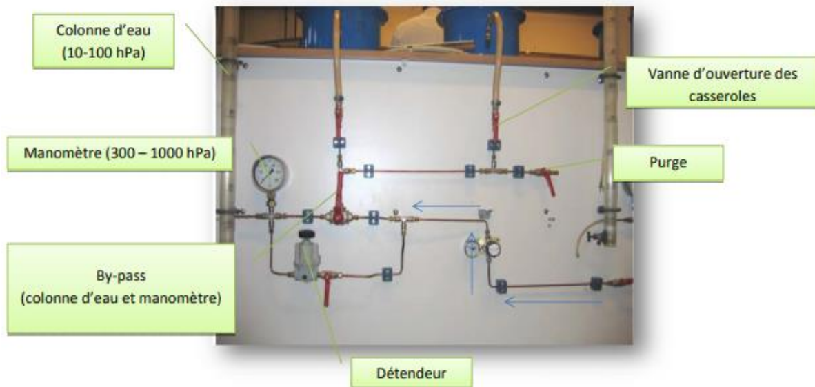
Figure 4 - Montage air comprimé pour Appareil de Richards
