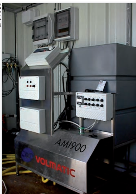
Station de fertigation avec un bac mélangeur couplée à un programmeur d'irrigation.
