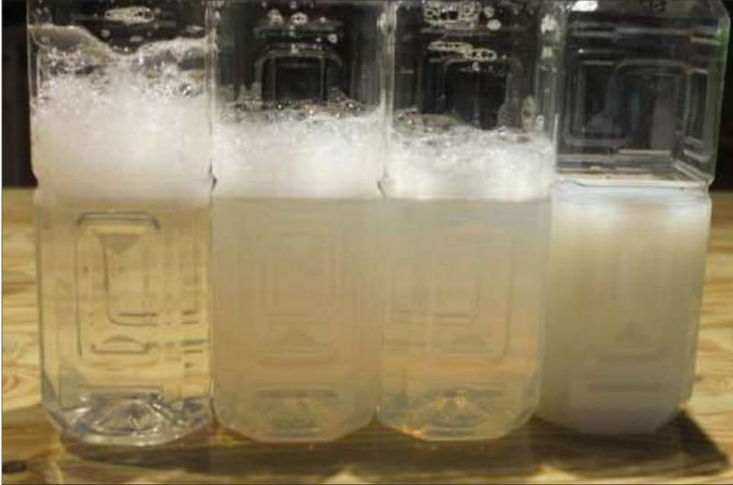
Test de l'eau avec agent mouillant JADAM. Mélangez quelques gouttes de JWA, l'eau doit rester claire. Secouez, il devrait y avoir beaucoup de mousse
