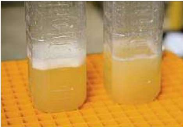
Les pesticides chimiques sont également affectés par l'eau. Ici, nous avons testé un pesticide commercial contre les acariens avec eau dure. Vous pouvez voir qu'il y a peu de mousse. Ceci signifie un pouvoir mouillant plus faible et donc une efficacité moindre en tant que pesticide.
