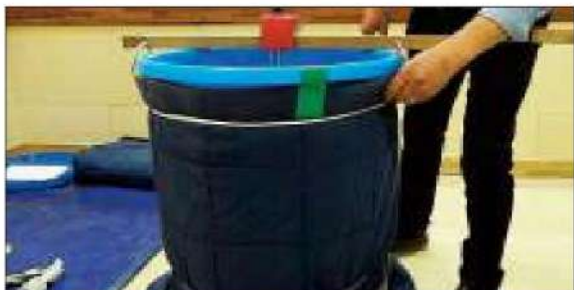
Envelopper d'isolant pour éviter que la chaleur ne s'échappe du côté ou du bas.
