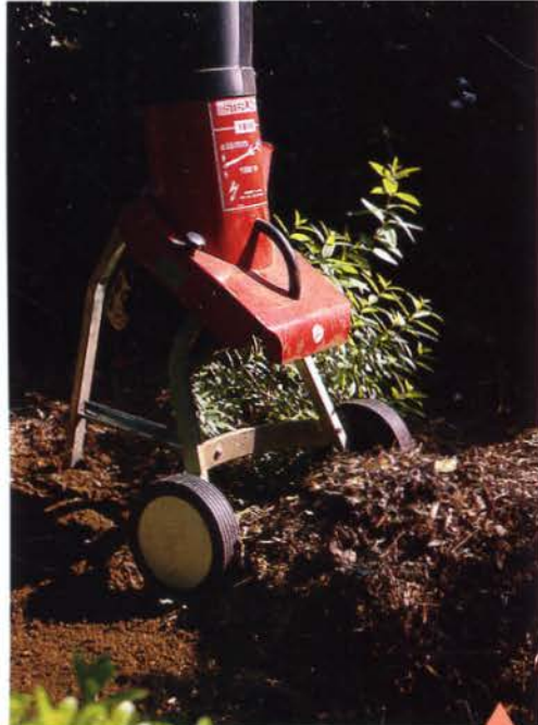
Un petit broyeur électrique permet de réduire le volume des déchets de plus des 3/4
