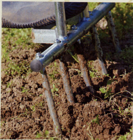
Les fortes dents de la fourche, en acier de bon diamètre et biseautées à leur extrémité, pénètrent sans effort dans le sol, qui est ameubli sans être retourné lors de la manœuvre de rotation de l'outil.
