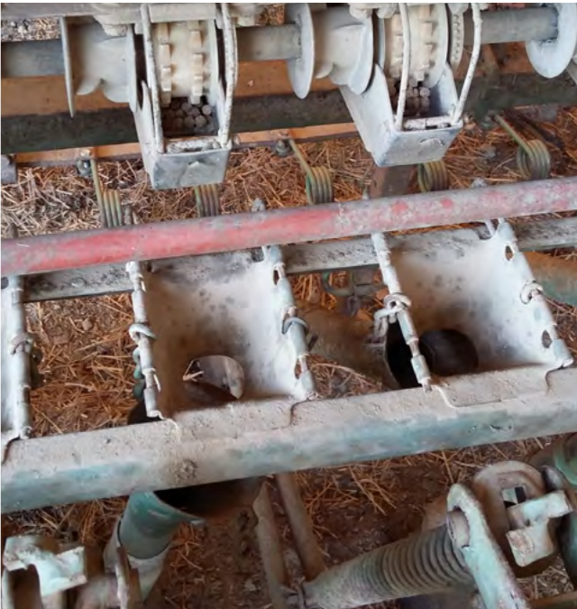
Fig. 15 : Les organes de distribution type ergots du semoir.
