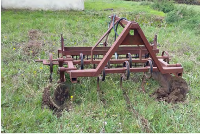
Fig.23 : Vibroplanche d'Erwan Humbert construit avec l'Atelier Paysan
