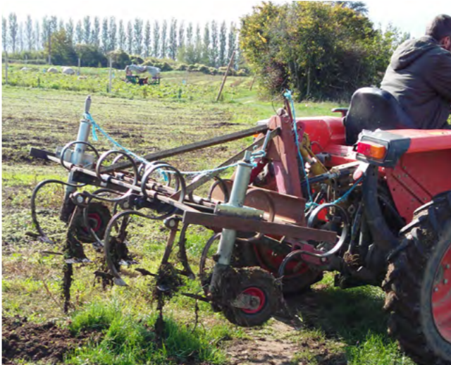
Fig. 5 : Bineuse utilisée pour préparer le lit de semence des engrais verts.
