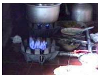
Photo 61. Cuisine fonctionnant au « biogaz »
