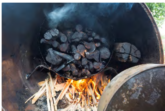
Photographie 8 : Le four à biochar permet de fabriquer du charbon de bois cuit par pyrolyse pour améliorer les sols selon la technique de la terra preta des anciens amérindiens d'Amazonie.
