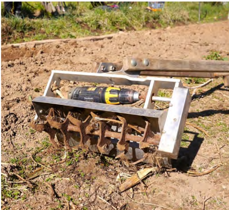
Photographie 3 : Le microculteur ou tilther, outil créé par Eliot Coleman pour travailler les 5 premiers centimètres du sol (broyage des résidus de culture, décompaction et incorporation du compost en surface).
