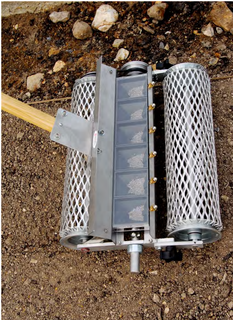
Photographie 10 : Eliot Coleman a mis au point un semoir de précision à six rangs qui permet de semer rapidement 12 rangs de petits légumes sur une planche permanente de 80 cm de large.
