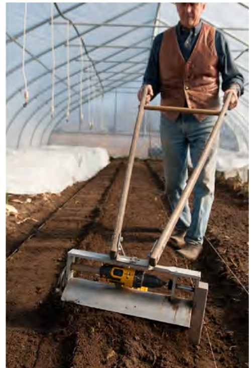
Photographie 3 : Le microculteur ou tilther, outil créé par Eliot Coleman pour travailler les 5 premiers centimètres du sol (broyage des résidus de culture, décompaction et incorporation du compost en surface).
