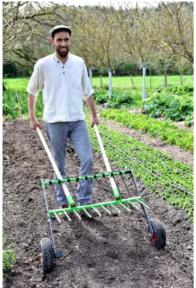
Photographie 2 : Vincent Legris (La Fabriculture) présente La Campagnole en largeur de 80 cm, adaptée aux planches plates. Noter les dents de herse étrille qui permettent de remonter les cailloux. A droite : position de transport.
