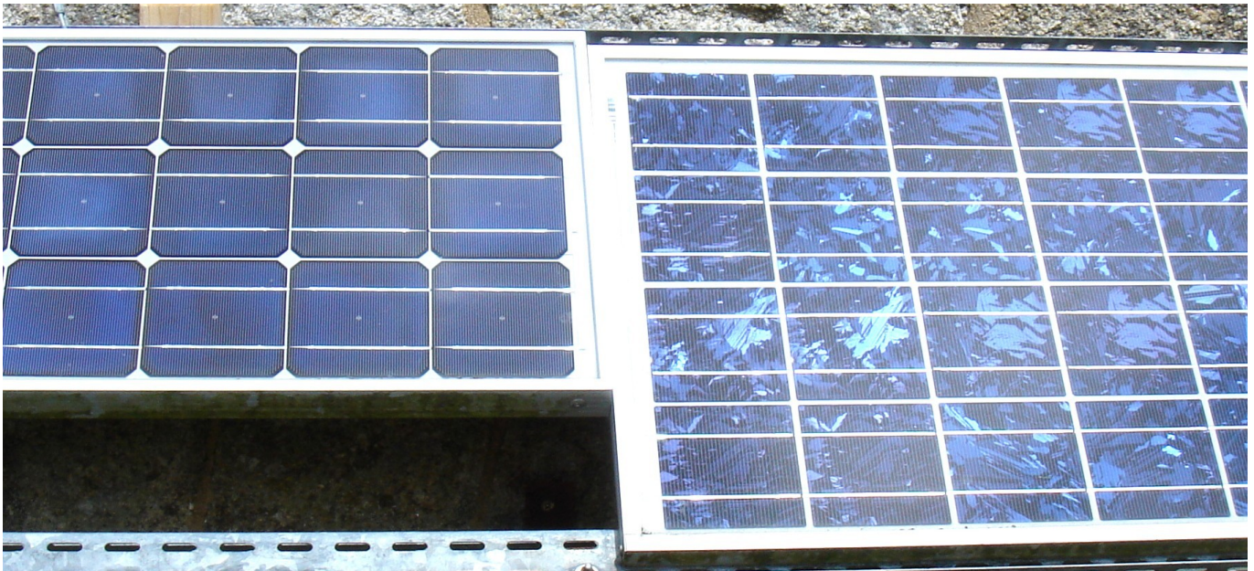
PV monocristallin à gauche et PV polycristallin à droite.
