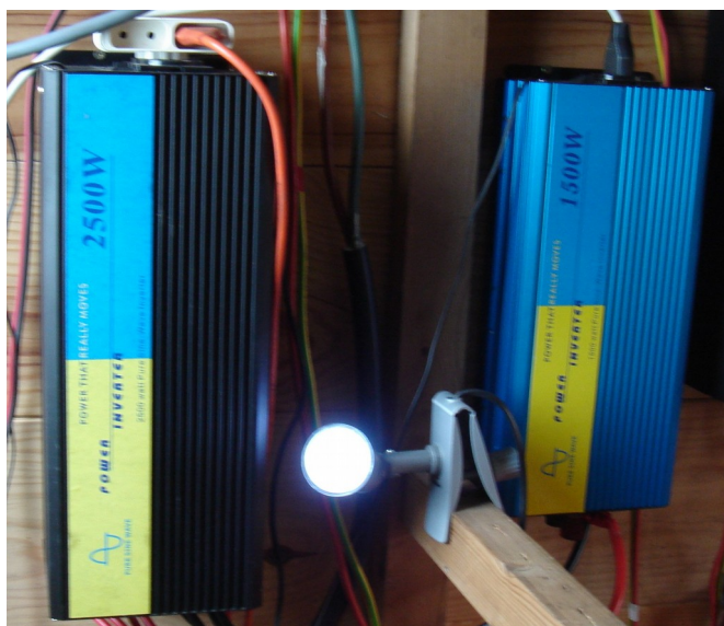
Ci-dessus : Onduleurs de 2500 W et 1500 W pur-sinus et à droite un 150W pseudo-sinus.
