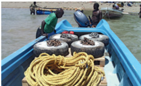
Système d'amarrage composé par des corps-morts (vieux pneus remplis de ciment), des morceaux de chaînes et des aussières d'amarrage (cordes jaunes dans la photo).
