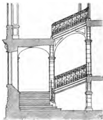
Fig. 900. — Escalier sur voûte en arc rampant.
