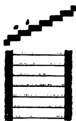
Fig. 898. — Escalier droit entre murs parallèles.
