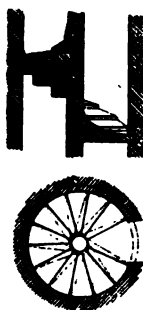
Fig. 908. — Escalier circulaire à noyau plein.
