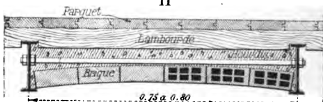
Fig. 758. — Hourdis en briques pleines et creuses.
