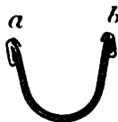
Fig. 996 et 997. — Chéneau Bigot-Renaux en fonte mince de 0 m ,004 à 0 m ,005 d'épaisseur, pouvant se dilater par bouts séparés et réduisant la pente à 0 m ,002 par mètre.
