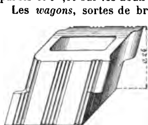
Fig. 1006. — Wagon dévoyé à joints horizontaux croisés (pour murs de 0 m ,35).
