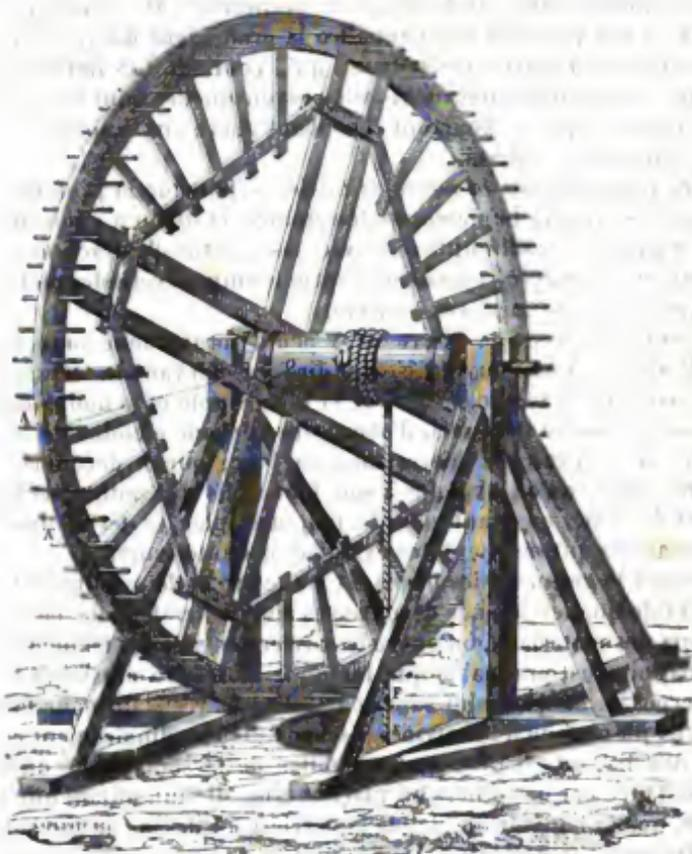
puits sont profonds et que les matériaux à élever sont abondants, les treuils sont manœuvrés par des chevaux ou par des machines à vapeur.
