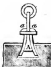
d'un petit instrument en fer, *fig. 57*, appelé *louve*, qui se compose d'une partie centrale A, taillée en queue d'aronde à sa partie inférieure et dont la tête porte un anneau qui s'accroche à l'esse du câble de la chèvre ou de la sapine, et de deux parties latérales a, a, d'épaisseur uniforme, légèrement recourbées d'équerre par le haut, et retenues à la pièce A par un anneau qui leur permet tout mouvement longitudinal quand la louve n'est pas chargée.
