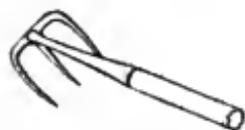
trois dents, *fig. 49*, ou au moyen de machines, quand on a de grandes quantités de béton à fabriquer.
