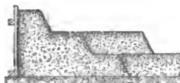
celles qui se feront les jours suivants. Lorsqu'on veut continuer une couche interrompue qui a eu le temps de sécher, on nettoie parfaitement la surface du redan, et l'on applique dessus une couche de mortier frais, sur laquelle on pose le nouveau béton. On prend également cette précaution pour raccorder une couche, qui a eu le temps de sécher, avec celle que l'on vient placer dessus.
