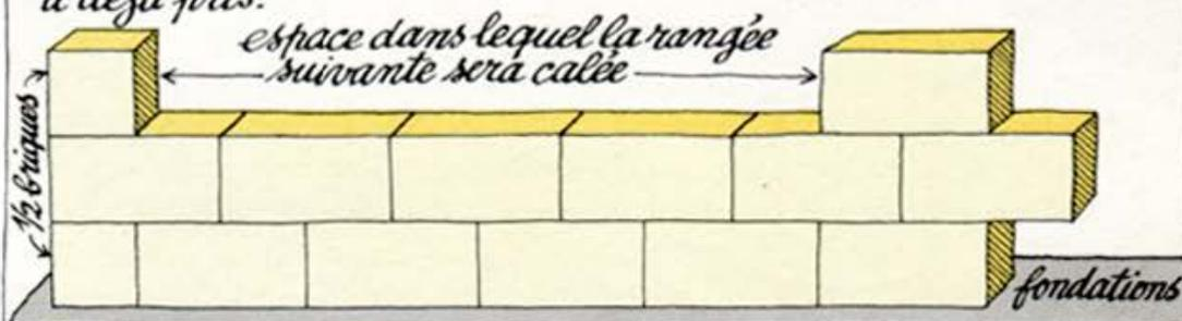
Pour les briques, faites des joints d'un centimètre, avec 2 baguettes en bois de cette épaisseur, vous pouvez contrôler la régularité du joint. Une fois que la brique est en place, bouvrez les interstices avec le fer à joints.
