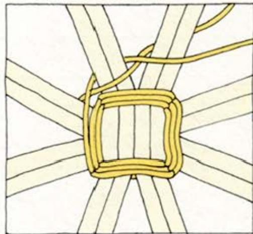
Maintenant, écartez tous les montants pour former une étoile à 16 branches et selon le même principe, continuez à tourner en relevant progressivement les montants afin de former le creux du panier. Lorsque vous avez terminé de tresser un brin, les deux bouts doivent être à l'intérieur du panier. Prenez un autre brin, pliez-le en deux, mettez-le à cheval sur le montant précédent et continuez à tourner.
