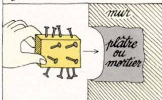
Pour sceller une pièce métallique, il faut scier l'extrémité et écarter les deux parties en les tordant.
