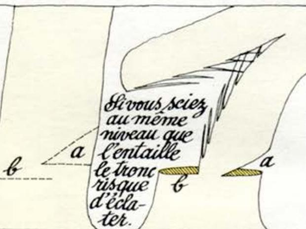
Si le tronc est vertical ou s'il est penché du mauvais côté, il est préférable d'utiliser un palan accroché à une branche haute et solide. Il faut plusieurs personnes pour tirer et il faut assurer l'arbre avec une autre corde pour qu'il ne puisse pas tomber du mauvais côté en cas de défaillance de l'équipe au palan. La longueur du palan doit faire au moins deux fois la hauteur de l'arbre. La coupure à la scie doit être oblique pour éviter au tronc de glisser.
