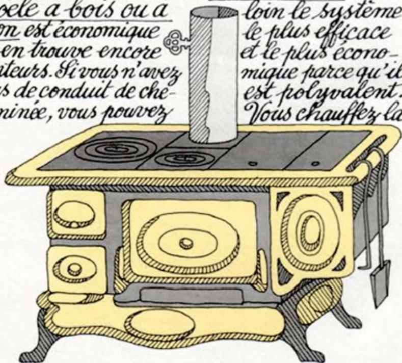
pièce en même temps que vous faites la cuisine. Les modèles les plus intéressants comportent un bac à eau chaude, un four, un emplacement pour mettre les briques qui réchauffent les lits, un chauffe-plats, etc.
