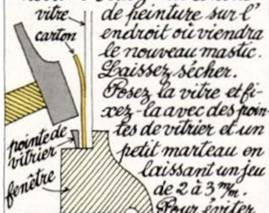
de peinture sur l'endroit où viendra le nouveau mastic. Laissez sécher. Posez la vitre et fixez-la avec des pointes de vitrier et un petit marteau en laissant un jeu de 2 à 3 mm.
