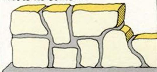
Pour les murs extérieurs faites une pente ou un arrondi au sommet afin que les eaux de pluie s'écoulent.
