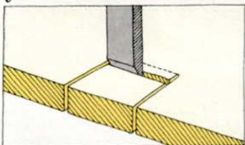
Remettez le ciseau au milieu et faites sauter le morceau de bois d'un coup sec. Rattrapez la ligne avec la râpe à bois demi-ronde en utilisant le côté plat.
