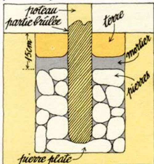
Posez une pierre plate au fond du trou. Mettez en place le poteau, caliez-le avec des grosses pierres jusqu'à 15 cm sous la surface du sol, puis coulez le mortier assez liquide pour qu'il pénètre entre les pierres. Laissez sécher trois jours sans remuer le poteau. Remettez la terre pour retrouver le niveau du sol.
