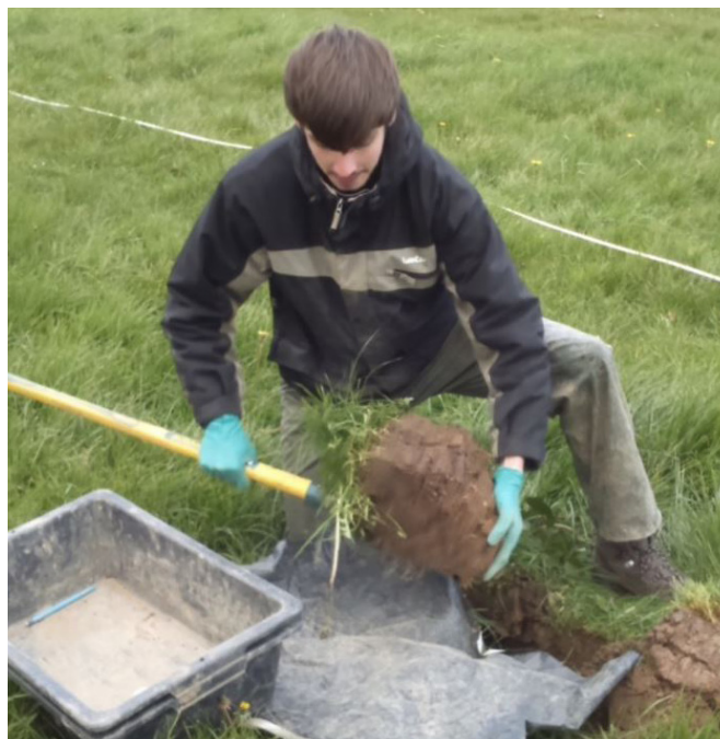
Prélèvements d'échantillons de sol pour les analyses microbiennes et nématofauniques (à gauche; © Sol Paysage) et test bêche pour l'échantillonnage lombricien (à droite; © Université de Rennes 1)
